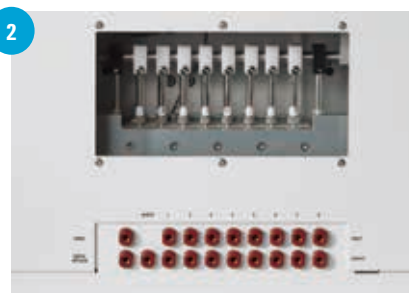
内蔵型ロータリーピストンシリンジポンプにより、界面活性剤を含むメディアをはじめとするさまざまなメディアに対応し、メディアによりポンプスピードを可変できます。
