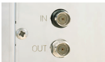
外部検出器と直接接続
