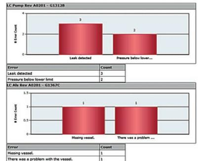
エラー履歴レポートには、モジュールのエラーに関するリストとグラフが記載されます。上の例では、継続的なカラムリークが特定され、カラムの適切な交換方法に関するトレーニングを追加する処置が取られました。
