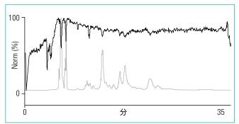
イオン抑制機能 (上トレース) とリン脂質の溶出 (下トレース) に相関性が見られます。
