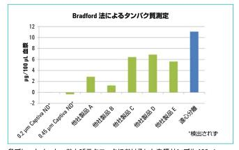
各プレートメーカーおよびテクニックにおけるヒト血漿サンブル 100 μL (n=24、4:1 ACN 沈殿) の沈殿後の平均タンパク質含有量
