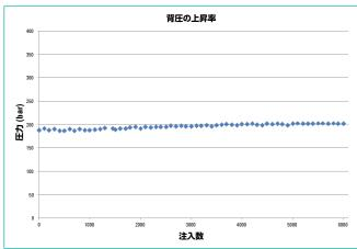
Captiva ND Lipids プレートで精製したヒト血漿サンプル連続 6000 回注入時の背圧の上昇。分析には、UHPLC システムと UHPLC カラムを使用しました。結果: 6000 回注入の全体にわたって、Captiva ND Lipids を用いたろ過により、背圧の上昇率が最小限に抑えられました (~7 %)。
