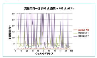
Agilent Captiva ND プレートは、迅速かつ均一にサンプルを処理します。 さらに、その均一なフローにより真空処理が容易になり、自動化システムに 対応可能です。
