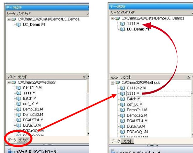
3) シーケンスメニューから「シーケンステーブル」を選択して解析のシーケンスを表示させ、解析メソッドを変更したいデータのメソッドを先ほど付け加えたmethodに変更し再解析を押します。
