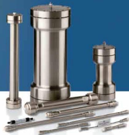
Poroshell 120 カラムのもうひとつの特徴として、sub2  $\mu\text{m}$  カラムよりも詰まりにくいということが挙げられます。sub2  $\mu\text{m}$  カラムは優れた高速高分離カラムですが、フリットの孔径が通常のカラムよりも細かいため、溶離液やサンプルに含まれる微小な粒子によって詰まりやすいという問題も抱えています。一方、Poroshell 120 カラムのフリットは5  $\mu\text{m}$  カラムと同じサイズの孔径ですので、sub2  $\mu\text{m}$  カラムよりも詰まりにくくなっています。
