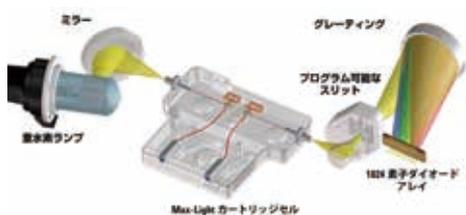
図 13. Agilent 1260/1290 Infinity ダイオードアレイ検出器 (Agilent Max-Light フローセル付き) のオプティカルダイクス (光学流体) 導波路。
