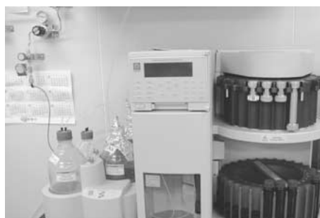
図 3c 前処理：高速溶媒抽出
