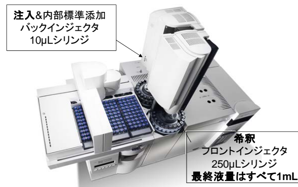
Fig.1 オートサンプラの構成図
